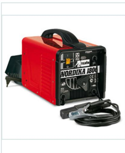
Poste de soudage à électrode, MMA, en courant alternatif (AC). Réglage continu du courant de soudage. Protection thermostatique. Electrodes utilisables: rutiles. Fourni avec accessoires de soudage MMA.
